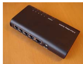
5 port LAN switch
